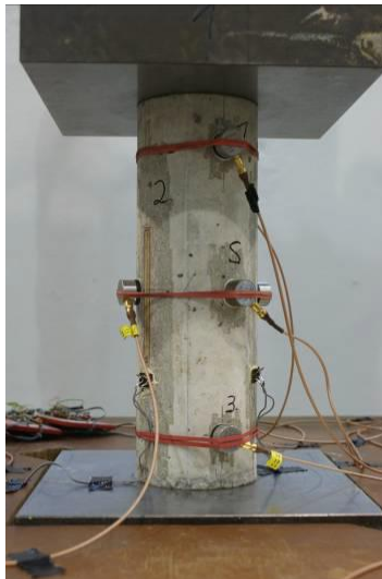
Abbildung 10. links: Probekörper mit Schallemissionssensoren zwischen den Druckplatten der Prüfmaschine rechts: nicht maßstäbliche Darstellung eines Ausschnitts der Belastungsfunktion, nach [13]
